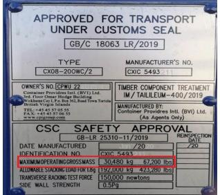
Maximum gross weight はドアに記載されている Maximum gross weight と CSC plate に記載されているものが一致していることが条件となります。
